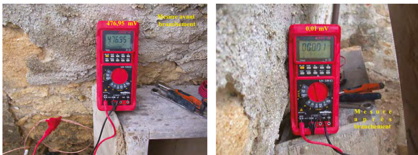
Fig. 1 : Illustration des relevés de courant avant et après pose de l'anneau-correcteur
