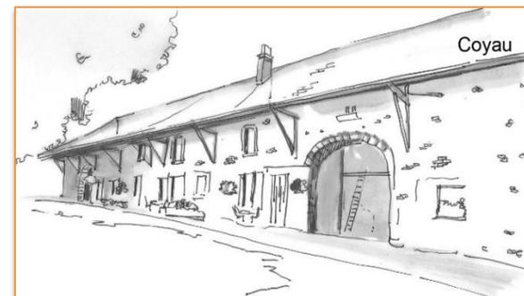
**Coyau** : Pièce oblique d'un versant de toit, portant sur le bas des **chevrons** et adoucissant la pente du versant dans sa partie basse.
