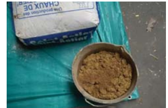
Enduit à la chaux
