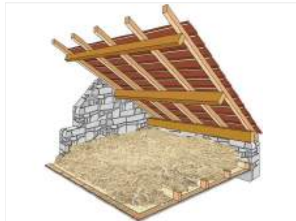
Principe de base : il s'agit de remplacer le foin entreposé dans le grenier par un isolant.
