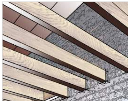
Plancher en bois désolidarisé
