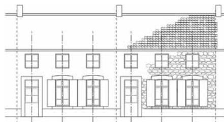
Les petites fenêtres carrées des combles en surcroît sont axées sur les ouvertures du rez-de-chaussée. Cité Huret à Saint-Étienne-au-Mont, construite en 1865
