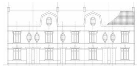
Les linteaux en ciment permettent une augmentation de la surface vitrée. Cité du Tilleul à Maubeuge, construite en 1927
