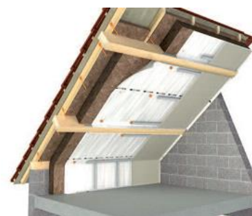
Isolation de rampant avec freine-vapeur (Schéma : Knauf)
