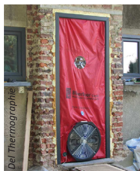
À gauche : Infiltrations d'air fréquentes dans les bâtiments. À droite : Test blower door - côté extérieur et intérieur.
