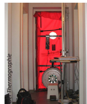
À gauche : Infiltrations d'air fréquentes dans les bâtiments. À droite : Test blower door - côté extérieur et intérieur.
